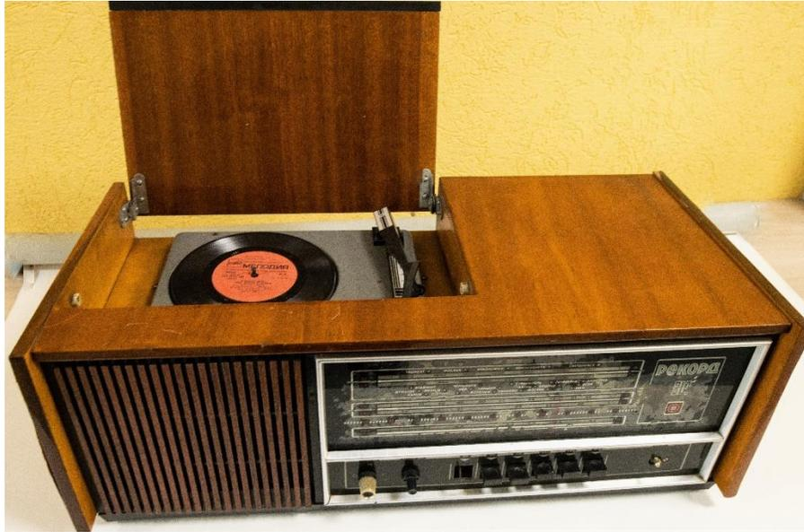
Радиола "Рекорд-314" с 1976 года выпускалась Бердским радиозаводом. Радиола состоит из радиоприёмника 3 класса и ЭПУ, позволяющего проигрывать грампластинки любого формата. Приёмник работает в диапазонах ДВ, СВ, двух поддиапазонах КВ и в УКВ-ЧМ диапазоне.
