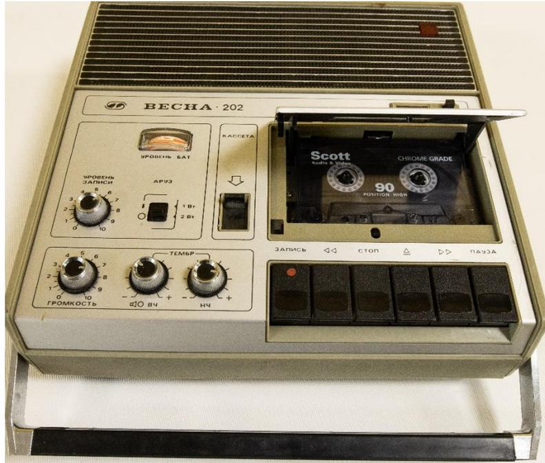
Портативный кассетный магнитофон 2-го класса "Весна-202" с 1977 года выпускал Запорожский электромашиностроительный завод "Искра". Магнитофон имеет повышенную выходную мощность, систему шумоподавления, ручную регулировку уровня записи и АРУЗ.
