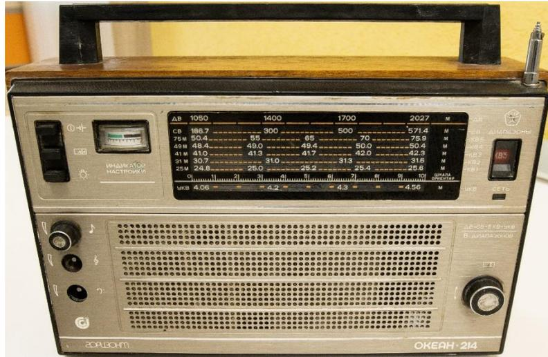
Переносной радиоприёмник "Океан-214" с 1985 года выпускало Минское ПО "Горизонт". Радиоприёмник второй группы сложности "Океан-214" предназначен для приёма в диапазонах ДВ, СВ, КВ (5) и УКВ.
