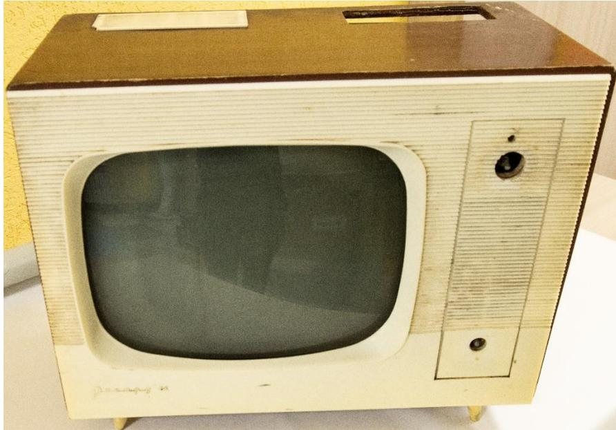
Телевизор "Рекорд-64" с 1964 года выпускал Воронежский завод "Электросигнал". Телевизор показывал чёрно-белое изображение. С начала 1966 года по такой же конструкции и электрической схеме (с незначительными доработками) завод выпускал телевизор "Рекорд-64-2"
